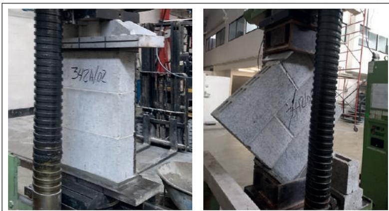
Fig.2 Pilas y Muretes para la obtención de los valores de diseño de la mampostería
