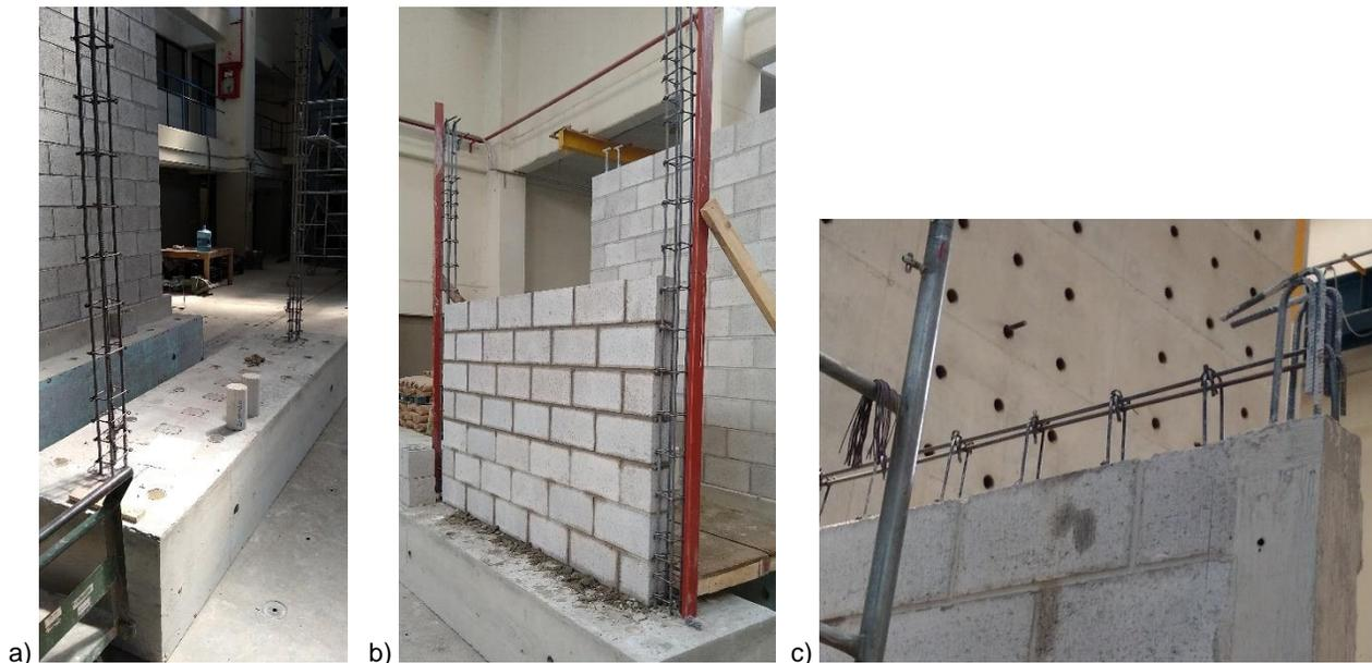
**Figura B.4 Construcción del espécimen MBC-2:**
