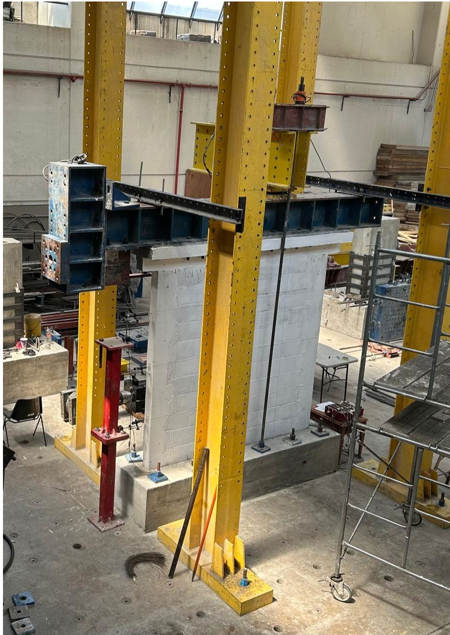
Figura 9 Aspecto del muro MH8R4 en el CENAPRED
