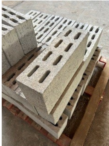
Figura 3 Pieza BH8S 12×20×40 cm, multiperforada 76% de área neta.
